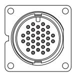
QUICK CONNECT TYPE SINGLE KEY 31-POSITION #20 PIN CONTACT
